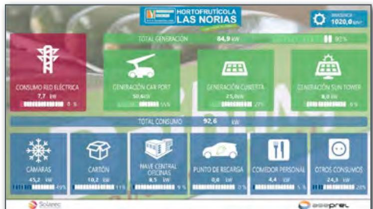
La integración de todas las actuaciones realizadas en los diferentes proyectos en una misma plataforma mediante la aplicación de monitorización y supervisión **POWER STUDIO SCADA** permite no sólo cuantificar la producción solar de cada uno de los sistemas sino también realizar el seguimiento de la evolución de los consumos de cada sección productiva de las empresas así como el impacto de las diferentes acciones de ahorro energético implantadas.
